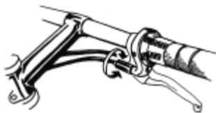
*Регулировочные втулки на шифтерах*
